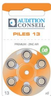
Les aides auditives fonctionnent avec des piles boutons zinc-air. Ces piles produisent de l'énergie par l'oxydation du zinc qu'elles contiennent avec l'oxygène de l'air ambiant. Pour les activer, il faut les laisser à l'air pendant une minute après avoir enlevé la languette hermétique qui garantit leur conservation dans l'emballage. C'est le temps qu'il faut en général
